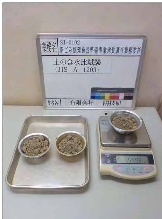
土の含水比試験
