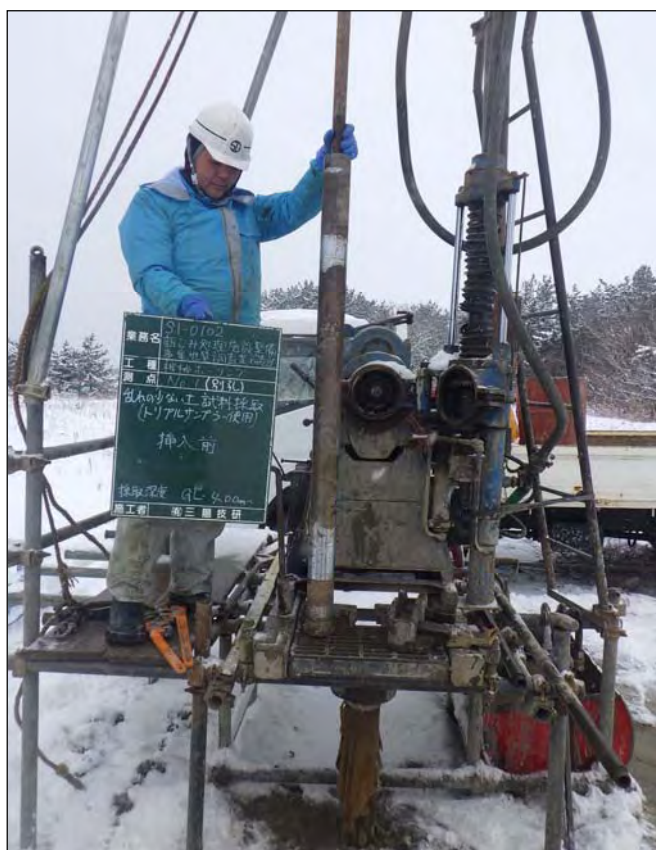
乱れの少ない土試料採取(挿入前)
