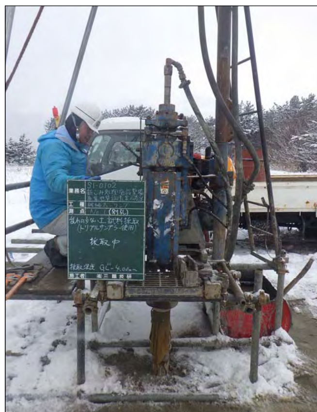
乱れの少ない土試料採取(採取中)
